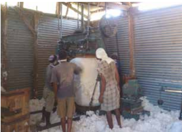
Illustration 7. Presse et emballage des fibres en balles
